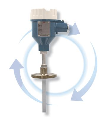
耐强酸强碱溶液的防腐热电偶、热电阻采用PTFE等防腐材质,作为整体保护套管或两节式套管,也可以直接在铠装丝材上作该材质的防腐处理。防腐形式分喷涂、烧结和衬套三种形式,适用于在强酸或强碱腐蚀性介质中进行测量,最高耐温250℃。
