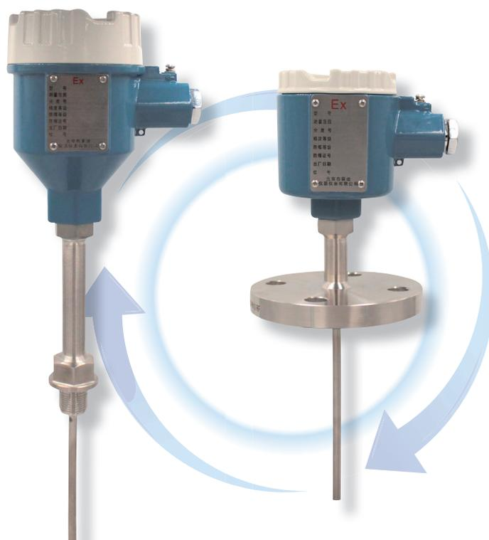
隔爆式热电阻用于存在碳氢化合物等爆炸性混合物的煤炭、石油、化工、冶金等场所，用来测量-200~+650℃范围内的液体、气体等介质的温度。利用间隙隔爆原理，设计具有足够强度的接线盒等部件，将所有会产生火花、电弧和危险温度的零部件都密封在接线盒腔内。当腔内发生爆炸时，能通过接线面间隙熄火和冷却，使爆炸后的火焰和温度不传到腔外。
