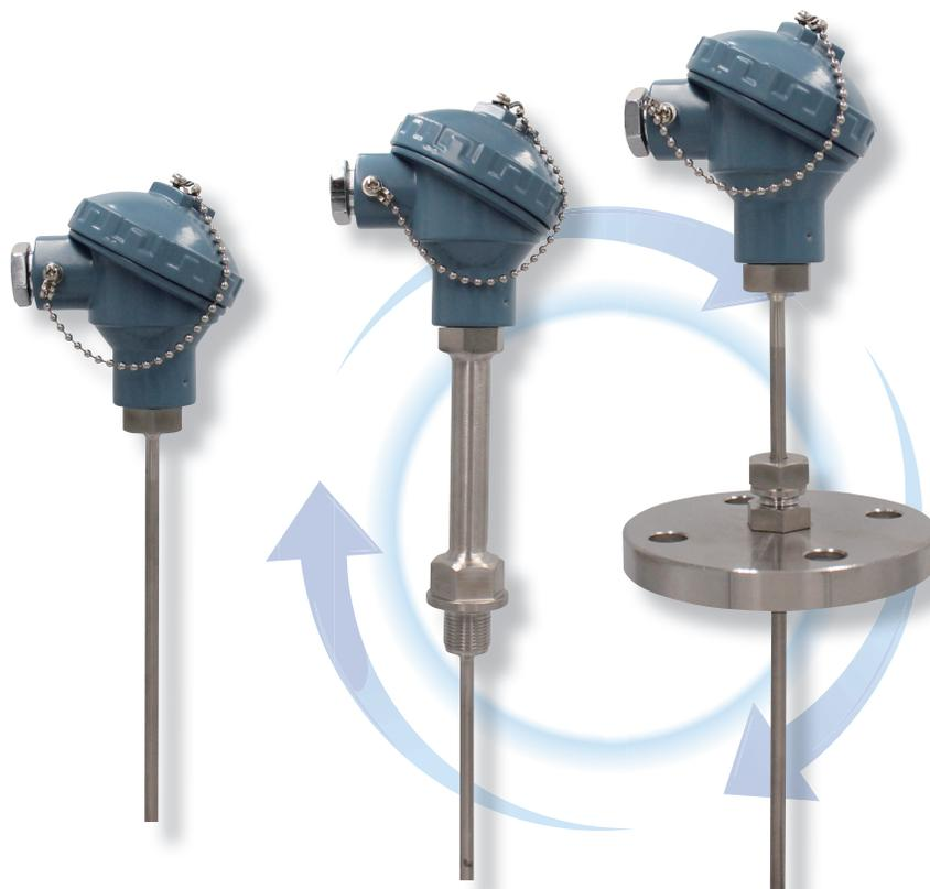
铠装热电阻材料是由几根（3根或6根）单种材料（镍丝）为芯线，与无机绝缘物及金属套管封装后，压实成拉制成坚实组合体，称为铠装热电阻材料，经与电阻感温元件、绝缘材料和金属保护管通过氩弧焊连接封装，成为用来测量温度的铠装热电阻感温元件。该产品主要由接线盒、内引级及铠装热电阻感温元件组成基本结构，再配以各种安装固定装置组成。铠装热电阻的测温元件与装配式热电阻相同，作为温度测量的传感器与显示仪表或计算机等配套使用，可直接测量和控制工业生产过程中-200~+650℃范围内的液体、蒸汽和气体介质以及固体表面等温度。广泛应用于石油、化工、电力、冶金、食品等工业和科研领域。
