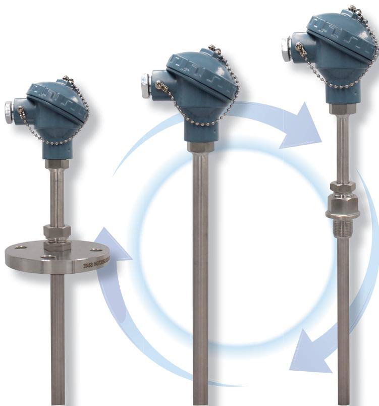
WZ系列装配式热电阻有铂热电阻和铜热电阻两大类，它们是由铂和铜作为感温材料的温度检出器，铂热电阻元件主要分为薄膜型和绕线型。热电阻通常和显示仪表等配套，直接测量各种生产过程中-200~+650℃范围内液体、气体介质以及固体表面的温度。
