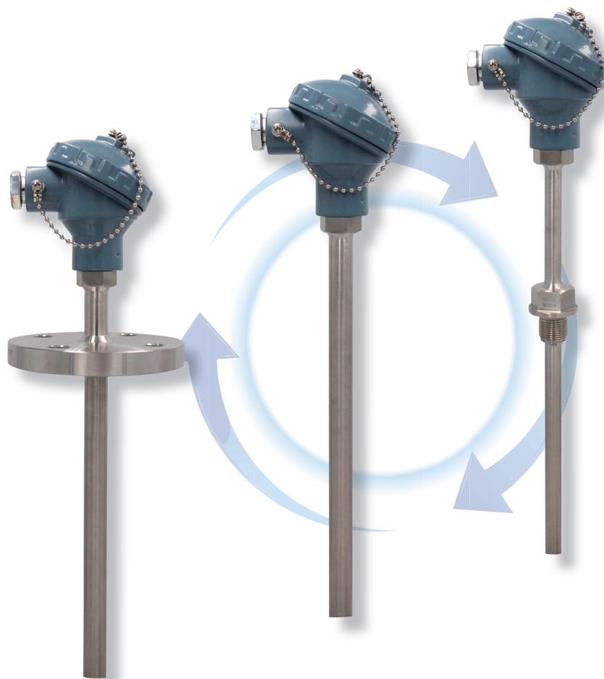
装配式热电偶可直接测量各种-200~+1800℃范围内液体、气体介质以及固体表面的温度，通常与显示仪表和计算机配套使用。它结构简单、测温准确、价格低廉、维修方便，广泛用于石油、化工、冶金、电力、机械、食品、塑料、热处理等工业部门，是一种理想的温度检测器，我公司生产的热电偶有铂铑30-铂铑6、铂铑13-铂、铂铑10-铂、镍铬-镍硅、镍铬-铜镍、铜-铜镍和铁-铜镍等七种，均符合IEC和国家有关标准。
